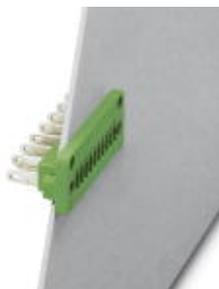
Компоненты для проходного монтажа, номинальный ток: 8 А, расчетное напряжение (III/2): 160 В, полюсов: 11, размер шага: 3,81 мм, тип подключения: Контакты под пайку / разъем для подключения плоского штекера, цвет: зеленый, поверхность контакта: олово, монтаж: Непосредственный монтаж
