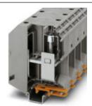
Клемма для высокого тока, номинальное напряжение: 1000 В, номинальный ток: 415 А, тип подключения: Винтовые зажимы, количество точек подсоединения: 2, сечение: 70 мм² - 240 мм², AWG: 2/0 - 500 kcmil, ширина: 36 мм, высота: 123,6 мм, цвет: серый, тип монтажа: NS 35/15, NS 32
