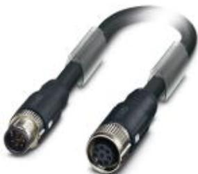
Системный кабель шины, VARAN (100 Мбит/с), 6-полюсн., SANTOPRENE без галогенов/TPE без галогенов, черный RAL 9005, экранирован., Штекеры прямое M12 SPEEDCON, А-кодирование, к Гнездо прямое M12 SPEEDCON, А-кодирование, длина кабеля: 2 м
