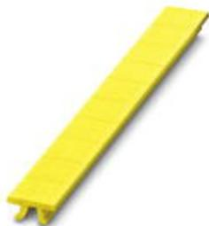
Планка Zack, возможен заказ: в лентах, желтый, надписи в соответствии с требованиями заказчика, тип монтажа: крепление в высоких пазах для табличек, для клемм шириной: 10,2 мм, размер маркировочного поля: 10,5 x 10,15 мм
