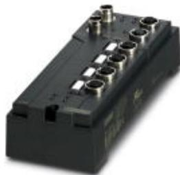
Локальное устройство имеет 4 аналоговых выхода. Особенности: 2 диапазона вывода тока и 4 – напряжения, переключение между 500 кВод и 2 МВод, обмен технологическими данными или данными РСР, точная диагностика каналов, защита от короткого замыкания / перегрузки, система быстрого подключения M12
