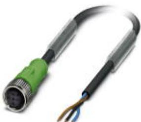
Кабель для датчика / исполнительного элемента, 3-полюсн., PUR без галогенов, темно-серый RAL 7021, свободный конец, к Гнездо прямое M12, А-кодирование, PIN 2+4 с перемычкой, длина кабеля: 10 м
