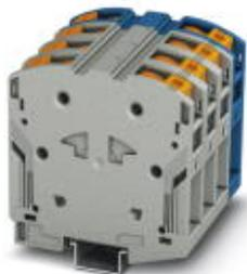
Клемма для высокого тока, блокированный, номинальное напряжение: 1000 В AC / 1500 В DC, номинальный ток: 150 А, тип подключения: Зажим Power-Turn, количество точек подключения: 8, полюсов: 4, сечение: 10 мм<sup>2</sup> - 70 мм<sup>2</sup>, AWG: 8 - 2/0, ширина: 80 мм, цвет: серый/синий, тип монтажа: NS 35/15
