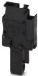
Штекер, номинальное напряжение: 500 В, номинальный ток: 24 А, тип подключения: Пружинный зажим, Штекерное подключение, количество точек подсоединения: 1, полюсов: 1, сечение: 0,08 мм<sup>2</sup> - 4 мм<sup>2</sup>, AWG: 28 - 12, ширина: 5,2 мм, высота: 39 мм, цвет: черный
