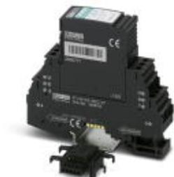
Защита от перенапряжений, включает в себя защитный штекер и базовый элемент, с встроенной многоступенчатой индикацией состояния на модуле для одной 2-проводной сигнальной цепи без потенциала земли.
