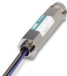
Устройство защиты от импульсных перенапряжений в форме модуля с резьбовым соединением, степень защиты IP 67, для измерительных датчиков, наружная резьба M20 x 1,5 для непосредственного монтажа, резьбовой сальник для сигнальных проводов, двухкаскадная схема защиты. Совместимость с HART.
