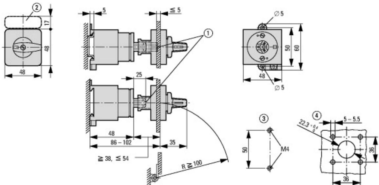
① Возможно удлинение вала с ZAV-T0, макс. 4 x 25 = 100 мм
