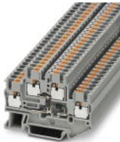
Клеммный блок, со встроенным диодом 1N4007, Макс. ток определяется типом диода. Встроенные диоды 1N 4007, запирающее напряжение: 1300 В, допустимый ток нагрузки при длительной работе: 0,5 А., номинальное напряжение: 500 В, номинальный ток: 0,5 А, тип подключения: Зажимы Push-in, количество точек подсоединения: 4, сечение: 0,14 мм<sup>2</sup> - 4 мм<sup>2</sup>, AWG: 26 - 12, ширина: 5,2 мм, высота: 45,8 мм, цвет: серый, тип монтажа: NS 35/7,5, NS 35/15
