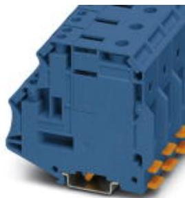
Клемма потенциальные блоки, номинальное напряжение: 1500 В DC / 1000 В AC, номинальный ток: 192 A, тип подключения: Винтовые зажимы, Винтовые зажимы, количество точек подсоединения: 5, полюсов: 1, сечение: 16 mm<sup>2</sup> - 95 mm<sup>2</sup>, AWG: 4 - 3/0, ширина: 20,3 мм, высота: 79,4 мм, цвет: синий, тип монтажа: NS 35/7,5, NS 35/15, NS 35/15-2,3, NS 32
