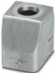
Сальниковый корпус B6, Крепление производится одной защелкой, материал: Из алюминия, методом литья под давлением, стойкий к морской воде, длина кабеля: 1, прямое, высота: 52 мм, кабельный ввод: без, патрубок: Нет, 1x M20, Стандартн.
