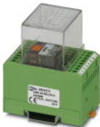
Релейный модуль со впаянными промышленными реле, контакты: 2 переключающих, для передачи сигналов общей неисправности, со входной диодной сборкой с общим катодом (6 диодов 1N4007), конденсатором, установленным параллельно катушке, и общим световым индикатором, входное напряжение 24 В DC
