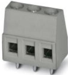
Клеммы для печатной платы, номинальный ток: 17,5 А, номинальное напряжение: 400 В, размер шага: 5 мм, полюсов: 3, тип подключения: Винтовой зажим с натяжной гильзой, монтаж: Пайка волной припоя, направление подключения, проводник/печатная плата: 0 °, цвет: сигнальный серый. Возможна установка в ряд модулей с различным количеством полюсов (контактов)!
