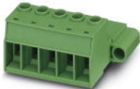
Разъемы для печатной платы, номинальный ток: 76 A, расчетное напряжение (III/2): 1000 В, полюсов: 3, размер шага: 10,16 мм, тип подключения: Винтовой зажим с натяжной гильзой, цвет: зеленый, поверхность контакта: Серебро
