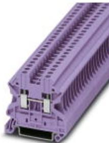
Проходные клеммы, номинальное напряжение: 1000 В, номинальный ток: 24 А, тип подключения: Винтовые зажимы, количество точек подсоединения: 2, сечение: 0,14 мм<sup>2</sup> - 4 мм<sup>2</sup>, AWG: 26 - 12, ширина: 5,2 мм, цвет: фиолетовый, тип монтажа: NS 35/7,5, NS 35/15
