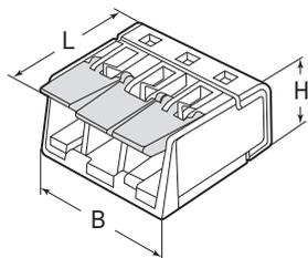
Габаритные размеры клемм в мм.
