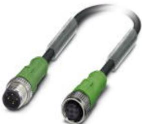
Кабель для датчика / исполнительного элемента, 4-полюсн., PUR без галогенов, темно-серый RAL 7021, Штекеры прямое M12, А-кодирование, к Гнездо прямое M12, А-кодирование, длина кабеля: 8 м
