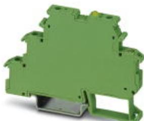
Полупроводниковое реле ввода, с ответным импульсом выхода постоянного тока, частота передачи 100 кГц, со световым индикатором и защитной схемой во входной и выходной цепи, вход: 24 В пост.тока, выход: 14-30 В пост.тока/50 мА
