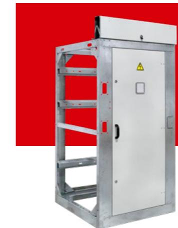
Корпусы камер серии КСО-366, КСО-304 на номинальное напряжение 6 и 10 кВ переменного трехфазного тока частоты 50 и 60 Гц предназначены для распределительных устройств сетей с изолированной или заземленной через дугогасящий реактор нейтралью.
