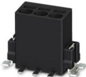
Клеммы для печатной платы, номинальный ток: 6 А, номинальное напряжение: 160 В, размер шага: 2,5 мм, полюсов: 8, тип подключения: Пружинные зажимы Push-in, монтаж: SMD пайка, направление подключения, проводник/печатная плата: 90°, цвет: черный. Набор SAMPLE с 5 артикулами в ленточной секции. Для пайки используйте изделие без маркировки SAMPLE
