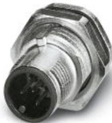
Встраиваемая штекерная часть разъема для датчика / исполнительного элемента, 5 контактов, M12-SPEEDCON, с механическим ключом А-типа, монтаж с задней части стенки / резьбовое крепление Pg9, с прямыми выводами под пайку, исполнение с выводами под пайку длиной 12 мм
