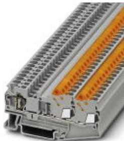
Проходные клеммы, тип подключения: Быстрое подключение, Пружинный зажим, сечение: 0,5 мм<sup>2</sup> - 2,5 мм<sup>2</sup>, AWG: 20 - 14, ширина: 6,2 мм, цвет: серый, монтаж: NS 35/7,5, NS 35/15
