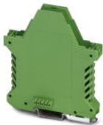
Установочный корпус, длина: 99 мм, с вентиляционными отверстиями, Нижняя часть корпуса, поперечное соединение: встроенный шинный соединитель, цвет: зеленый, ширина: 17,5 мм, высота: 114,5 мм, кол-во контактов поперечного соединителя: 5
