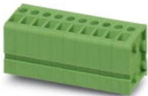
Клеммы для печатной платы, номинальный ток: 24 А, номинальное напряжение: 400 В, размер шага: 5 мм, полюсов: 12, тип подключения: Фронтальные винтовые зажимы, монтаж: Пайка волной припоя, направление подключения, проводник/печатная плата: 90°, цвет: зеленый. Возможна установка в ряд модулей с различным количеством полюсов (контактов)!
