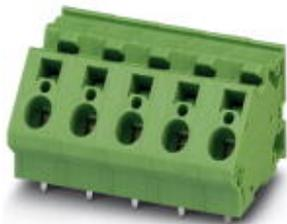
Клеммы для печатной платы, номинальный ток: 32 А, номинальное напряжение: 630 В, размер шага: 10 мм, полюсов: 1, тип подключения: Пружинный зажим, монтаж: Пайка волной припоя, направление подключения, проводник/печатная плата: 45 °, цвет: зеленый. Возможна установка в ряд модулей с различным количеством полюсов (контактов)!
