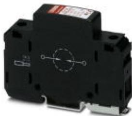
Молниезащитный разрядник (тип 1 / класс I / В) с герметичным искровым промежутком с амплитудным ограничением и электронной схемой зажигания, 1-канальный. Уровень защиты: 4 кВ. Ширина корпуса: 17,5 мм (1TE)
