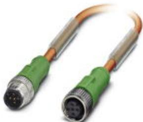
Кабель для датчика / исполнительного элемента, 5-полюсн., PUR без галогенов, отвержденный излучением, оранжевый RAL 2003, Штекеры прямое M12, A-кодирование, к Гнездо прямое M12, A-кодирование, длина кабеля: 0,6 м, Исполнения на заказ
