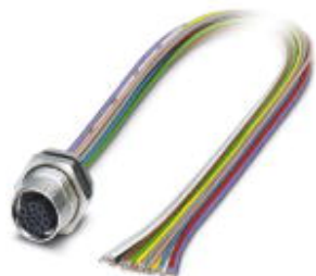
Гнездовая часть для датчика/исп. устройства, 17-контактн., M12-SPEEDCON, монтаж на задней панели / резьбовое крепление M16, с гибким безгалогенным проводом 0,5 м (TPE), 17 x 0,14 мм 2
