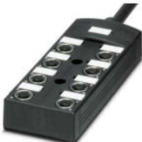
Коробка датчика и исполнительного элемента, применение: Внешние области, тип подключения: Розетка M12 металл, количество гнезд: 8, полюсов: 5, механические ключи: А - стандарт, гнездо для платы: Двойной, индикатор состояния: Нет, Универсальный; годключение магистрального кабеля: Жесткое подключение 180°, PUR/PVC, длина кабеля: 10 м, экранировка: нет
