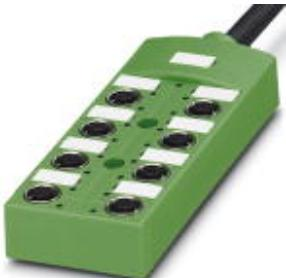
Коробка датчика и исполнительного элемента, применение: Стандартн., тип подключения: Гнездовой разъем M12-SPEEDCON металл, количество гнезд: 8, полюсов: 5, механические ключи: А - стандарт, гнездо для платы: Двойной, индикатор состояния: есть, р-п-р; подключение магистрального кабеля: Жесткое подключение 180°, PUR, не содержащий галогена, длина кабеля: 5 м, экранировка: нет
