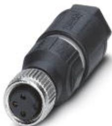
Соединитель для датчика/исполнительного устройства, 3-полюсн., Гнездо прямое M8, А-кодирование, Клеммы с ножевыми контактами, материал накатанной гайки: Цинк. литья под давлением, с никелевым покрытием, наружный диаметр кабеля 2,5 мм ... 5 мм
