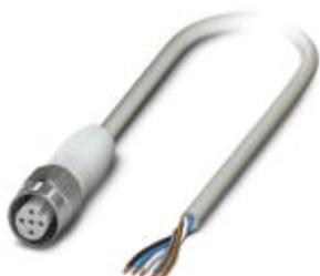
Кабель для датчика / исполнительного элемента, 5-полюсн., PP-EPDM без галогенов, серый RAL 7035, свободный конец, к Гнездо прямое M12, А-кодирование, длина кабеля: 5 м, Гигиеничный дизайн, с накатанной гайкой из легированной стали
