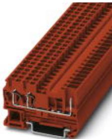
Проходные клеммы, номинальное напряжение: 500 В, номинальный ток: 24 А, тип подключения: Штекерное соединение / пружинный зажим, количество точек подсоединения: 3, полюсов: 1, сечение: 0,08 мм<sup>2</sup> - 4 мм<sup>2</sup>, AWG: 28 - 12, ширина: 5,2 мм, цвет: красный, тип монтажа: NS 35/7,5, NS 35/15
