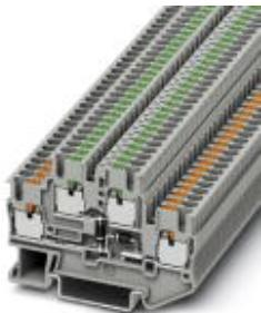
Клеммный блок, со встроенным диодом 1N4007, Макс. ток определяется типом диода. Встроенные диоды 1N 4007, запирающее напряжение: 1300 В, допустимый ток нагрузки при длительной работе: 0,5 А., номинальное напряжение: 500 В, номинальный ток: 0,5 А, тип подключения: Зажимы Push-in, количество точек подсоединения: 4, сечение: 0,14 мм<sup>2</sup> - 4 мм<sup>2</sup>, AWG: 26 - 12, ширина: 5,2 мм, высота: 45,8 мм, цвет: серый, тип монтажа: NS 35/7,5, NS 35/15
