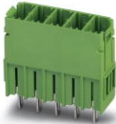
Корпусная часть для печатных плат, номинальный ток: 41 A, расчетное напряжение (III/2): 630 В, полюсов: 10, размер шага: 7,62 мм, цвет: зеленый, поверхность контакта: олово, монтаж: Пайка волной припоя
