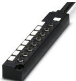
Коробка датчика и исполнительного элемента, применение: Стандартн., тип подключения: Гнездовая часть разъема M5 металл, количество гнезд: 8, полюсов: 4, гнездо для платы: Двойной, индикатор состояния: есть, р-п-р; подключение магистрального кабеля: Жесткое подключение 180°, PUR/PVC, длина кабеля: 5 м, экранировка: нет
