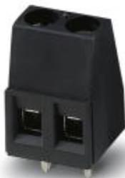
Клеммы для печатной платы, номинальный ток: 17,5 А, номинальное напряжение: 320 В, размер шага: 5,08 мм, полюсов: 10, тип подключения: Винтовой зажим с натяжной гильзой, монтаж: THR пайка, направление подключения, проводник/печатная плата: 0 °, цвет: черный. Возможна установка в ряд модулей с различным количеством полюсов (контактов)!
