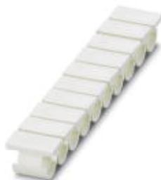
Маркировочные кольца для проводников, Полоса, белый, без маркировки, маркируется с помощью: CMS-P1-PLOTTER, тип монтажа: надевание, диапазон диаметра кабеля: 2,5 ... 4,7 мм, размер маркировочного поля: 5,5 x 10 мм
