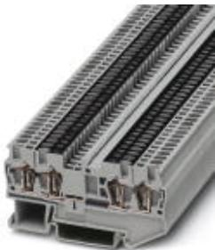
Проходные клеммы, номинальное напряжение: 500 В, номинальный ток: 17,5 А, тип подключения: Пружинный зажим, количество точек подсоединения: 2, сечение: 0,08 мм<sup>2</sup> - 1,5 мм<sup>2</sup>, AWG: 28 - 16, ширина: 4,2 мм, цвет: серый, тип монтажа: NS 35/7,5, NS 35/15
