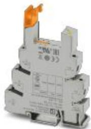
14 мм базовая клемма PLC без установленного реле, для монтажа на несущую рейку NS 35/7,5, Винтовые зажимы, 1 переключающий контакт, Входное напряжение 24 В AC/DC
