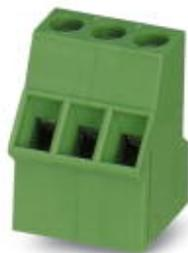
Клеммы для печатной платы, номинальный ток: 20 А, номинальное напряжение: 400 В, размер шага: 5,08 мм, полюсов: 3, тип подключения: Винтовой зажим с натяжной гильзой, монтаж: Пайка волной припоя, направление подключения, проводник/печатная плата: 50 °, цвет: зеленый
