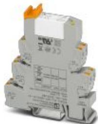
PLC-INTERFACE, состоит из основной клеммы PLC-BPT.../21-21 с разъемом push-in и вставным мини-реле с многосл. золотым контактом, для монтажной рейки NS 35/7,5, 2 переключающих контакта, входное напряжение 60 В DC
