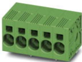
Клеммы для печатной платы, номинальный ток: 41 А, номинальное напряжение: 1000 В, размер шага: 7,5 мм, полюсов: 11, тип подключения: Пружинные зажимы Push-in, монтаж: Пайка волной припоя, направление подключения, проводник/печатная плата: 0 °, цвет: зеленый
