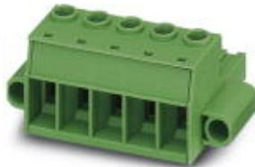
Разъемы для печатной платы, номинальный ток: 76 A, расчетное напряжение (III/2): 1000 В, полюсов: 5, размер шага: 10,16 мм, тип подключения: Винтовой зажим с натяжной гильзой, цвет: серый, поверхность контакта: Серебро
