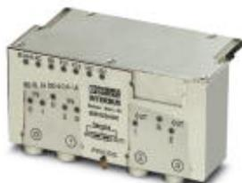
Устройство цифрового ввода-вывода для INTERBUS; оптоволоконная технология, скорость передачи 2 Мбод, четыре входа (24 В DC), два выхода (24 В DC, 0,5 А), подключение датчиков / исполнительных элементов посредством 5-контактных гнезд M12, прочный металлический корпус, степень защиты IP67
