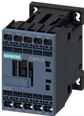
Силовой контактор, AC-3 12 A, 5,5 кВт/400 В 1 НО, 24 В DC 3-полюсн., типоразмер S00, пружинная клемма
