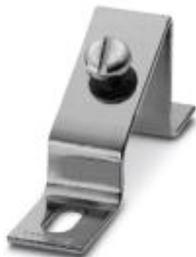
Угловой зажим с винтами М 6, закрепляет монтажную рейку в наклонном положении (под углом 30°), высота: 35,4 мм
